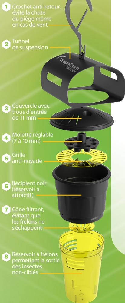
**1** Crochet anti-retour, évite la chute du piège même en cas de vent
